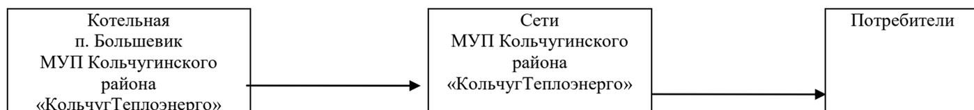
Водогрейная котельная Ильинского поселения находится в хозяйственном ведении МУП Кольчугинского района «КольчугТеплоэнерго». В качестве основного топлива на котельной используется каменный уголь. Тепловые пункты отсутствуют. Отопительный период длится 213 суток. На котельной п. Большевик не предусмотрена круглогодичная выработка тепловой энергии на горячее водоснабжение потребителей.
